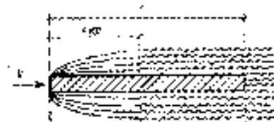
Рис. 9.5. Обтекание пластины, установленной вдоль потока
