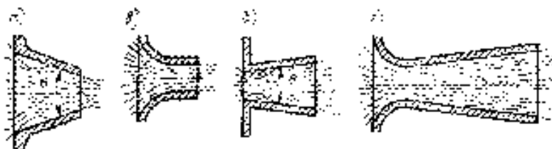
Рис. 7.11. Истечение через насадки: конический сходящийся (а) и расходящийся (б), конусообразный (в) и комбинированный (г)
