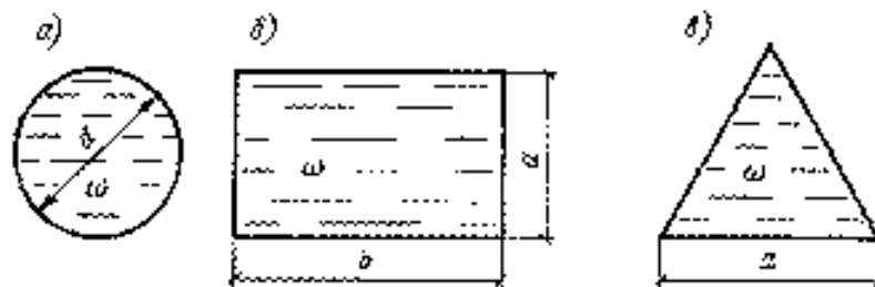
Рис. 4.5. Поперечные сечения потока различной формы: а — круглое; б — прямоугольное; в — треугольное
