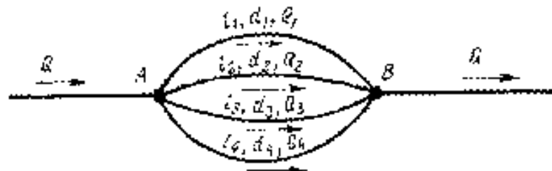
Рис. 6.3. Схема с гидравлическим расчету трубопровода с параллельным соединением участков
