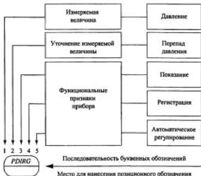
Рис. П1. Пример построения условного обозначения прибора для измерения, регистрации и автоматического регулирования перепада давления
