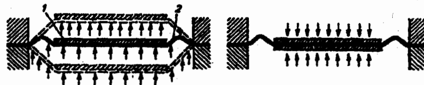
Рис.31. Кольцевая мембрана: а — с одним диском; б — с двумя дисками; 1 — диск; 2 — гофра
